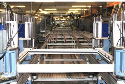
*Bildtext 11: Auf der modernen Kunststofffenster-Fertigungsstraße am Produktionsstandort Verl fertigt EGE hochkomplexe Qualitätsfenster. Foto: EGE*
