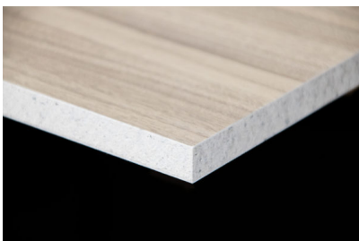
Bildtext 1: „A2-Solution“ ist ein nicht brennbares Verbundelement aus einer Gipsfaserplatte und einer in Anlehnung an die DIN EN 438-1 und EN 438-9 klassifizierten dekorativen 0,7 mm starken Laminatbeschichtung mit der Textur „Matte 58“. Foto: Homapal
