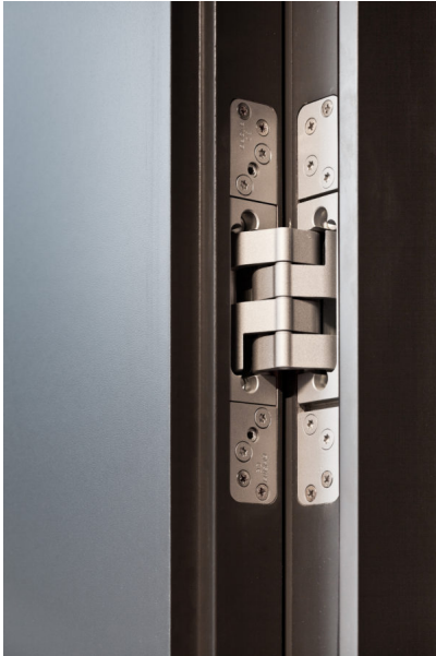
Bildtext 4: Das Herzstück des verdeckt liegenden Türbandes „Pivota DX 180 3D“ von BaSys: vier Kolben lagern das Gelenk und lenken die auftretende Kräfte in jede Richtung. Das Prinzip sorgt selbst bei extremen Gewichten für eine hohe Stabilität. Foto: Daniel Vieser Architekturfotografie, Karlsruhe, www.dv-a.de
