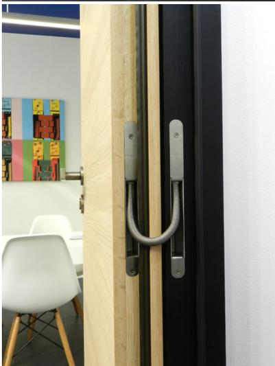
*Bildtext: Der Kabelübergang „Pivota Connect“ verschwindet in einer falzseitigen Fräsung und sichert die Energieversorgung zwischen Zarge und Türflügel – Voraussetzung, um die Tür mit zusätzlichen Sicherheits- und Komfortmerkmalen auszustatten. Foto: Basys*
