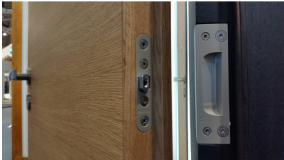
Bildtext 3: Mit einer externen Bandseitensicherung lassen sich Eingangstüren für die Widerstandsklasse RC3 sichern. Die Lösung von Basys wird flügelseitig mit einem entsprechenden Gegenstück in der Zarge montiert und bleibt für die sichere Verbindung justierbar. Foto: Basys
