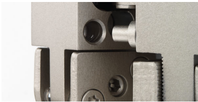
Bildtext 2: Die in das verdeckt liegende Band „Pivota DXS 300 Steel Safe“ integrierte Bandseitensicherung verhindert, dass sich der Türflügel horizontal oder vertikal verschieben lässt. Dabei greift ein gehärteter Stahlstift auf der Zargenseite in eine Bohrung mit Kragen auf der Gegenseite. Foto: Basys
