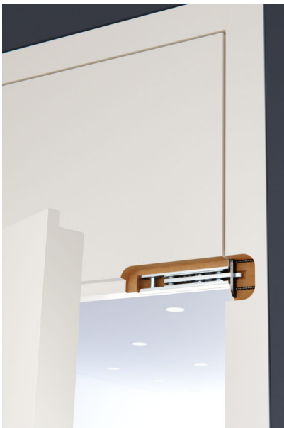
Bildtext 4: Dank des neuen dreidimensional justierbaren Blendenhalters lassen sich Oberblenden millimetergenau auf Türblatt und Zarge einstellen. Aus massivem Stahl konstruiert, eignet er sich auch für Türen in brandschutzrelevanten Bereichen. Foto: BaSys
