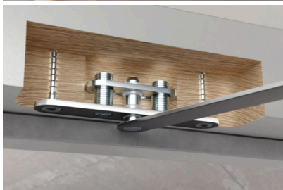
Bildtext 3: Im Gegensatz zu anderen ähnlichen Produkten schränkt der neue Öffnungswinkelbegrenzer von Basys die Höhenverstellung der Tür nicht ein; das Gegenlager in der Zarge ist ebenfalls höhenverstellbar und wandert bei der Justage mit. Foto: Basys
