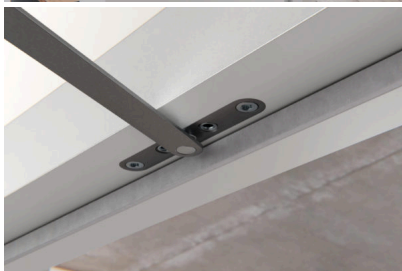
Bildtext 2: Im Gegensatz zu anderen ähnlichen Produkten schränkt der neue Öffnungswinkelbegrenzer von Basys die Höhenverstellung der Tür nicht ein; das Gegenlager in der Zarge ist ebenfalls höhenverstellbar und wandert bei der Justage mit. Foto: Basys
