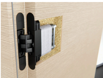
Bildtext 1: Der Türschließer macht gemeinsame Sache mit dem Band und verschwindet im Türblatt: Mit dem verdeckt liegenden Band „Pivota DXS Close 2.0“ schließen Türen sanft und selbsttätig. Foto: Basys
