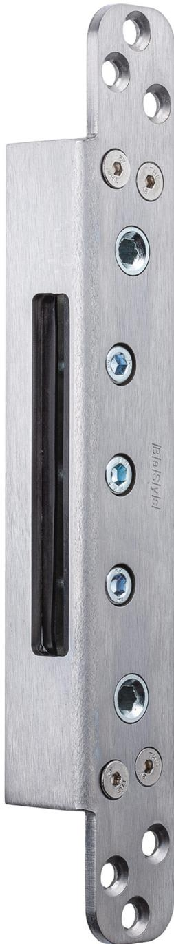
*Bildtext 3: Den Schlitz der Bandaufnahme „STV 135/56 3-D“ für Türgewichte bis 300 Kilogramm pro Paar stattete BaSys mit einer Dichtlippe aus, damit gerade bei Türen in der Gebäudehülle kein Regenwasser eindringen kann. Foto: BaSys*
