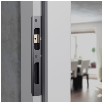
Bildtext: Erlaubt die Türjustierung von der Schließblechseite aus: Das neue „Stabilo-Schließblech 28 2-Loch leicht V2“. In der oberen Öffnung findet sich ein u-förmiges Edelstahlprofil, mit dem sich der Anpressdruck der Türdichtung einstellen lässt. Foto: Basys
