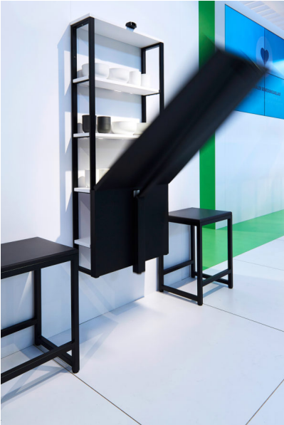
Bildtext 7: Besonders gut kam in Pordenone der „TopSwing“ an. Der kindersichere Klapp-Esstisch hängt platzsparend an der Wand und senkt sich bei Bedarf nach der Ein-Hand-Entriegelung dank integrierter Dämpfung sanft ab. Foto: Kesseböhmer
