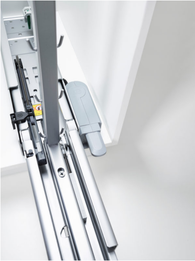
Fotografia 3: Una leggera pressione sul frontale di un "CONVOY", DISPENSA" o "TANDEM" è sufficiente – con il nuovo "eTouch+" l'armadio a colonna si apre di una fessura di (44 mm) ed afferrando da dietro con una mano può essere aperto. Il top: Se il frontale viene viene ulteriormente aperto, l'armadio si chiude automaticamente dopo circa tre secondi. Foto: Kesseböhmer
