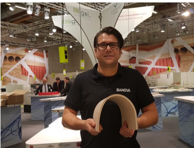
Bildtext 2: Mit eigenem Stand und einer Werkbank präsentierte die 3A Composites „Banova“, das weltweit leichteste Sperrholz, das auf Balsa-Furnieren basiert. In verschiedenen Variationen findet das Material Anwendung im Theater- und Ladenbau, im Caravan- und Yachtbau, im Möbelbau sowie im Handwerk bei Schiebetüren und Arbeitsplatten, erläutert Michael van Enschoot, Sales Manager Europe „Banova“. Auf der Sonderfläche „Tiny Spaces“ präsentierten Jessica Neumann und Tessa Sieker mit dem mit „Banova“ realisierten „Interior Case“ ein Konzept für minimalistisches Wohnen bei mobiler Lebensweise. Foto: igeL
