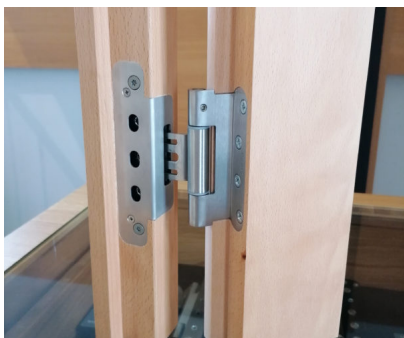
Bildtext: Mit „STV Inclino“ wird das Band für die Einstellung der seitlichen Falzluft innerhalb der Bandaufnahme erstmals gekippt. Das ermöglicht insbesondere im Bereich der leichteren Bandsysteme für Wohnungstüren die präzise und simple Einstellung in drei Richtungen. BaSys konzipierte „STV Inclino 3-D“ für alle Bänder mit einem handelsüblichen, aus dem Stahlzargenbereich bekannten Mittelteil. Foto: Basys
