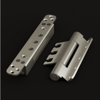
Bildtext 2: Das Rollenband für Objektüren „Objecta 2239/160/56-4 S“ mit „STV 135/56 3-D“ eignet sich für 350 Kilogramm schwere Türen. Foto: Basys
