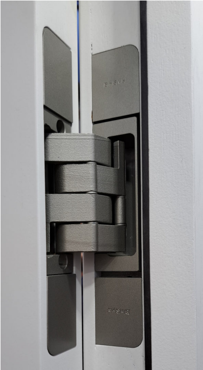
Bildtext 4: Eine neue Lösung, um Aufdopplungen sowohl auf Zargen- als auch auf Flügelseite von bis zu 10 mm zu überwinden, präsentierte Basys mit dem „Pivota DX 110 3-D“. Foto: BaSys
