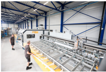
Bildtext 2: Das Aluminiumprofil-Durchlaufzentrum mit sechsspindeligen Ringmodul, 4-Achs-Schwenksäge von vorn sowie einer mit Werkzeugwechsler ausgestatteten Kämpferkonturfräse nahm Wirus im April 2023 in einer neu errichteten Halle in Betrieb. Foto: Schirmer Maschinen
