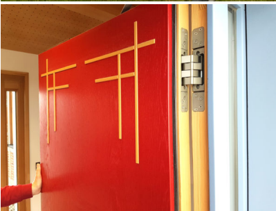
Bildtext 2: Bei dieser stumpf einschlagenden Haustür mit integriertem Motorschloss setzte die Tischlerei Holtkamp auf zwei verdeckt liegende Bänder „Pivota DX 120 3-D“ für Türgewichte bis 160 Kilogramm pro Paar. Die Bänder sind dreidimensional justierbar, die Lagerungen wartungsfrei. Durch die große Auslenkung eignen sie sich für Aufdopplungen. Foto: Basys
