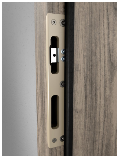
Bildtext: Erlaubt die Justierung gefälzter Türen von der Schließblechseite aus: Das neue „Stabilo-Schließblech 28 2-Loch“ in massiver Ausführung. In der oberen Fallenöffnung findet sich ein u-förmiges Edelstahlprofil, mit dem sich der Anpressdruck der Türdichtung einstellen lässt. Foto: Basys
