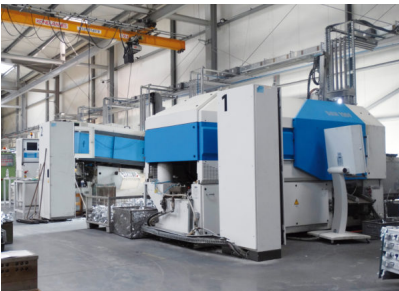
Bildtext 2: Schwinn-Standort in Krakau/Polen: Zinkdruckgussmaschinen. Foto: Schwinn
