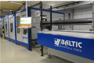
*Bildtext 2: Setzt Maßstäbe in Sachen Automatisierung: Das neue Schirmer-BAZ bei der Baltic Fenster GmbH in Langenhorn. Es übernimmt nun auch alle Arbeiten, die zuvor an Einzelplätzen per Hand verrichtet wurden, und zwar schneller, präziser und flexibler. Foto: Baltic*
