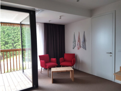
Bildtext 2: Bei den Zwischentüren in den Hotelzimmern schließt das Türblatt flächenbündig mit der Zarge ab. Die Technik bleibt im Verborgenen und die Tür wird in ihrer minimalistisch-puristischen Ausführung Teil der Wand. Foto: BaSys
