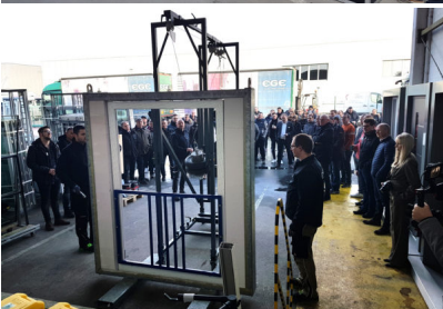
Bildtext 9: Großes Interesse zeigten die Teilnehmer der EGE-Fachhandelstage an den Pendelschlagversuchen zur Absturzsicherung. Foto: EGE
