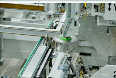
us_days_10.jpg: Die Schweißraupenverputz-Maschine SV 840 von Urban bei der Arbeit. Foto: Ingo Jensen/Urban
