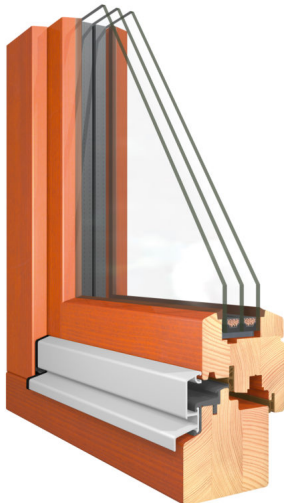
Bildtext 2 (4): EGE-Holzfenster und -Holztüren sind in deckenden RAL-Farben oder – für eine natürliche Holzoptik – in ausgewählten Lasurtönen erhältlich. Die thermisch getrennte Alu-Regenschiene schützt den witterungsempfindlichsten Bereich des Fensters. Foto: EGE
